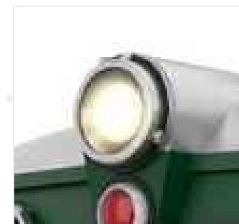
Große Lampenringe zierlich graviert, kleine als Metalldrehteil umgesetzt
