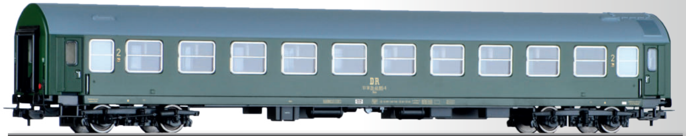
Reisezugwagen 2. Klasse Bm, Typ Y, der DR 2nd class passenger coach Bm, type Y, of the DR
