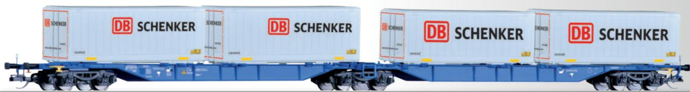
Doppeltragwagen Sggmrs 714 der DB AG, beladen mit vier Wechselbehältern
