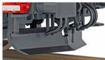
Schienenräumer am Chassis angesteckt
