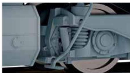
Aufwendige Nachbildung der Bremsanlage sowie Sandfallrohre
