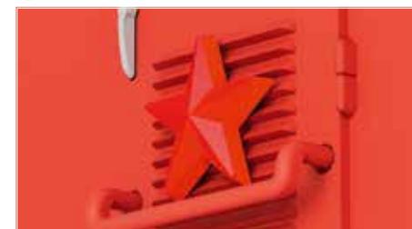
Separat angesetzter Stern und Griffstangen an der Lokfront
