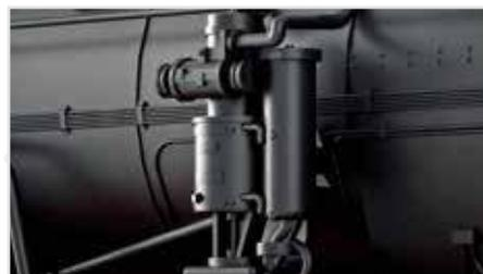
Speisepumpe Bauart VEB BBW KP4-250 mit Peters-Steuerung
