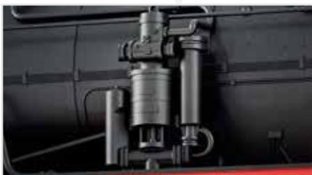
Speisepumpe Bauart Knorr KT1-250 mit Tolken-Steuerung
