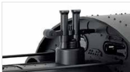
Sicherheitsventil der Bauart Ramsbottom
