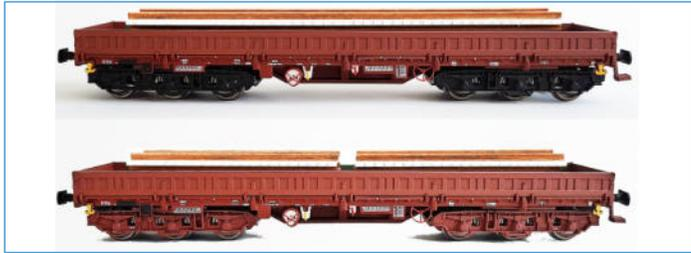
**2er Set mit 6-achsigen Schwerlastwagen Bauart Samms 4860 der DR** (Epoche IV), beladen mit Schwellenstapeln, Wagen 1, rotbraun mit schwarzen Drehgestellen, beladen mit einem Schwellenstapel lang und Wagen 2, rotbraun einfarbig, beladen mit zwei Schwellenstapel kurz
