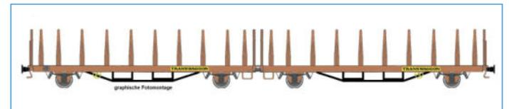
**4achsige Flachwagen-Doppelunit Bauart Laas 1 der Fa. Transwaggon** eingestellt bei der DB AG (Epoche V/VI) rotbraun einfarbig, unbeladen
