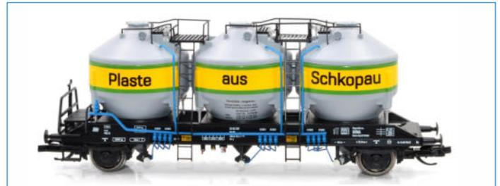
**2-achsiges Silowagen Bauart Uc-y der DR Plaste aus Schkopau**
