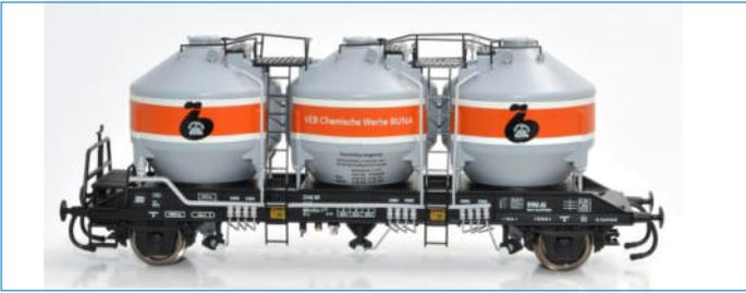
**2-achsiger Silowagen Bauart Uc-y der DR VEB Chemische Werke BUNA**
