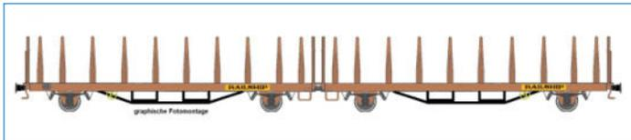
**4achsige Flachwagen-Doppereinheit Bauart Laas 1 der Fa. Railship**
