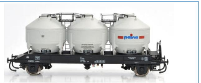
**2-achsiger Silowagen Bauart Uc-y der Peine AG HYDRATKALK**
