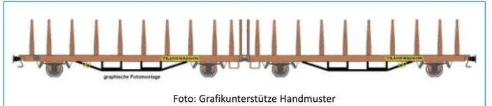
4achsige Flachwagen-Doppereinheit Bauart Laas 1 der Fa. Transwaggon eingestellt bei der DR (Ep. IV) rotbraun einfarbig, unbeladen
