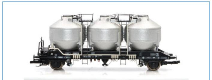
**2-achsiges Silowagen Bauart Zk der DR Messe-Prototyp NIESKY**
