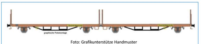
4achsige Flachwagen-Doppereinheit Bauart Laas 1 der Fa. Transwaggon eingestellt bei der DB AG (Ep.V/VI) rotbraun einfarbig, unbel., ohne Rungen
