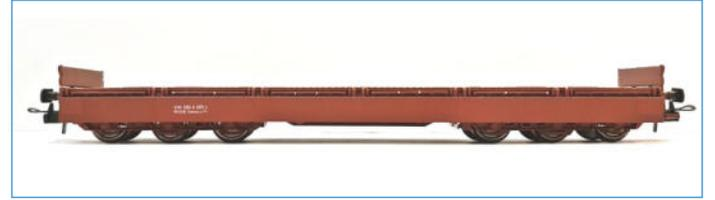
**6-achsiger Schwerlastwagen Bauart Samms-u 454 der DB AG** (Epoche V) braun, mit abgeklappten Bordwänden, 1. Betriebsnummer
