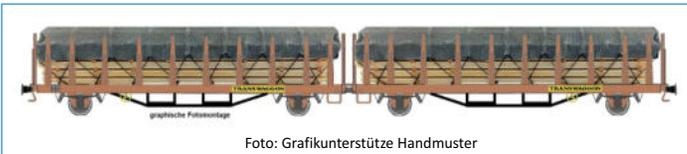
4achsige Flachwagen-Doppereinheit Bauart Laas 1 der Fa. Transwaggon eingestellt bei der DR (Ep. IV) rotbraun einfarbig, mit Holzbalken
