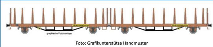
4achsige Flachwagen-Doppereinheit Bauart Laas 1 der Fa. Transwaggon eingestellt bei der DR (Ep.IV) rotbraun einfarbig, unbeladen
