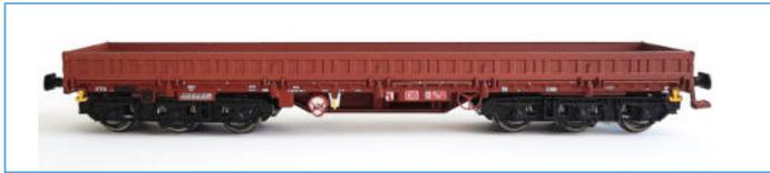
**6-achsiger Schwerlastwagen Bauart Samms-u 454 der DB AG** (Epoche V-VI), rotbraun, unbeladen
