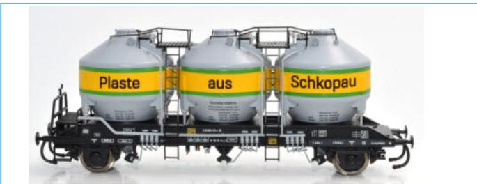
**2-achsiger Silowagen Bauart Uc-y der DR Plaste aus Schkopau**
