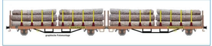
4achsige Flachwagen-Doppereinheit Bauart Laas 1 der Fa. Transwaggon eingestellt bei der DB AG (Epoche V/VI) rotbraun einfarbig, ExTe-Rungen, beladen mit Stammholz
