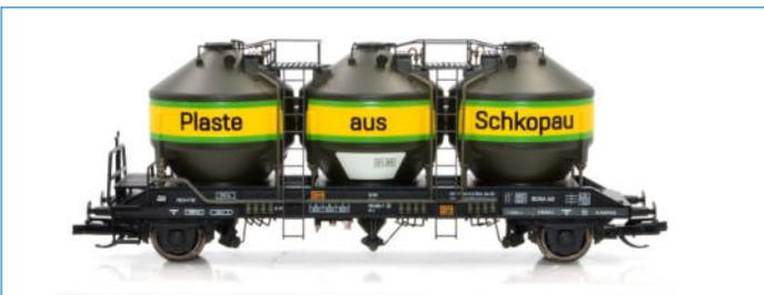
**2-achsiges Silowagen Bauart Uc-y der DR**
