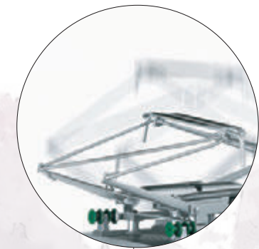
Stromabnehmer im Digitalbetrieb heb- und senkbar
