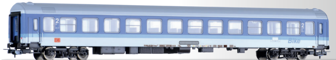
Reisezugwagen 2. Klasse mit Mehrzweckabteil Bimdz 267 der DB AG 2nd class passenger coach with multipurpose compartement Bimdz 267 of the DB AG
