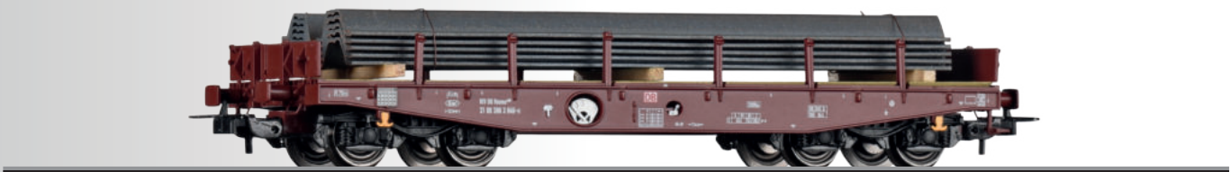
Schwerlastwagen Rmms 662 der DB AG, beladen mit Spundwänden Flat car Rmms 662 of the DB AG with load
