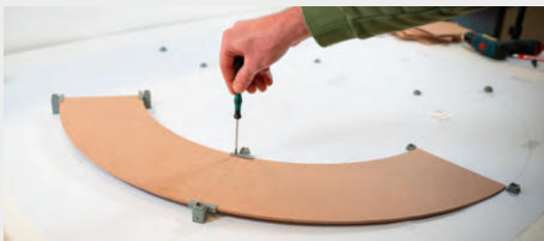
Der Grundkreis wird direkt auf dem beiliegenden Plan aufgebaut. Die Bodenplatten werden mit Schrauben auf der Grundplatte befestigt.
