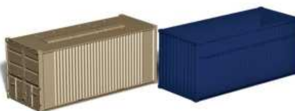
Ref. S6013 - contentor 20' topo aberto para transporte de Petcoke
