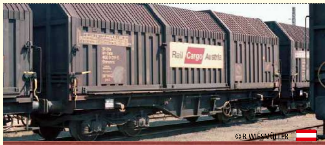
Teleskophaubenwagen Shimms ÖBB, Rail Cargo Austria Betriebs-Nr. 31 80 4671 273-9
